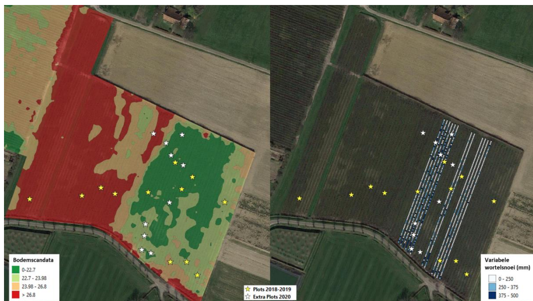
Figuur 3. Kaart van proefperceel “Baarlo” met de resultaten van de bodemscan (links) en de taakkaart voor variabele wortelsnoei (rechts) waarbij de diepte van het wortelmes gevarieerd werd. De sterren duiden de ligging van de experimentele plots aan. Plots aangeduid in het wit werden pas vanaf 2020 opgevolgd.
